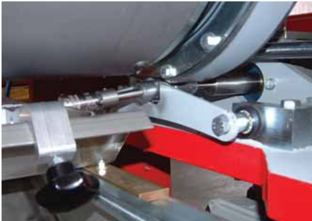
Überlaufwanne mit wenig Inhalt - 5L/lfm. Variabler Dosierrollenantrieb. Overflow tray with small content - 5L/rm Variable drive of the Dosingroll.
